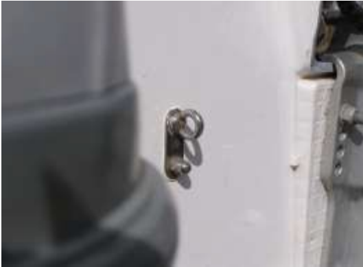
Rückansicht: Hinterer Festmacherring
