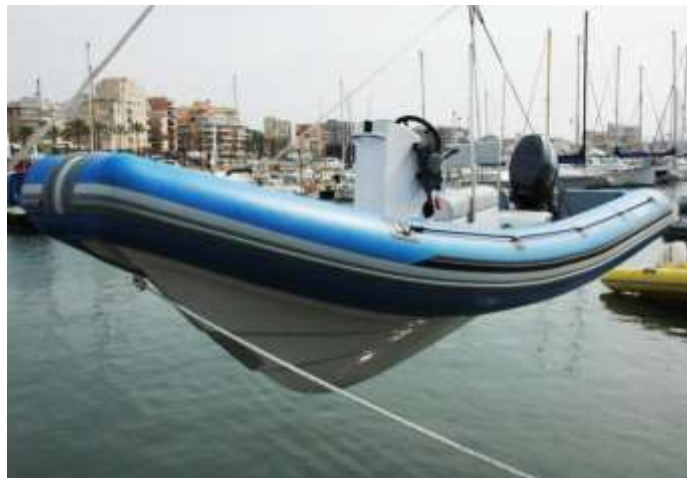
Heben Sie das Boot wie gezeigt an. Achten Sie darauf, dass die Schlingen nicht unter dem Leistungshebel oder dem Lenkrad geführt werden.
