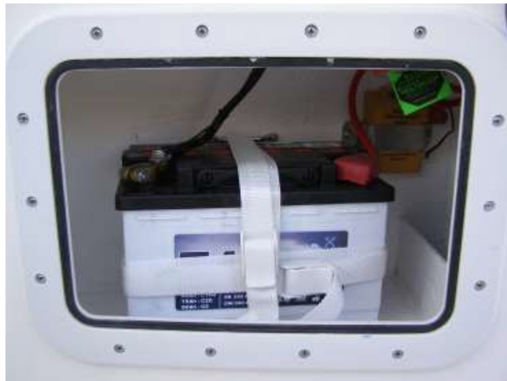
Die Batterie muss ordnungsgemäß platziert und mit Riemen befestigt werden.
