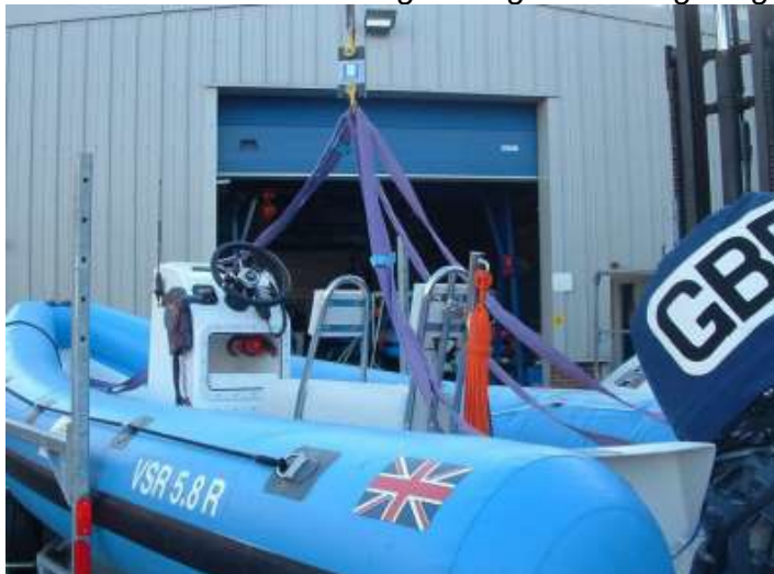
Heben Sie das Boot wie gezeigt an. Achten Sie darauf, dass die Schlingen nicht unter dem Leistungshebel oder dem Lenkrad geführt werden.
