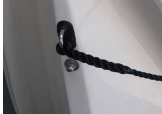
Frontansicht: Vorderer Festmacherring mit Abschlepptau
